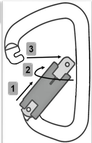
**Verschluss immer korrekt verschließen und kontrollieren.**
