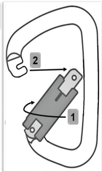
**Triple-Lock-Verschluss** – 1 Heben, 2 Drehen dann 3 Öffnen
