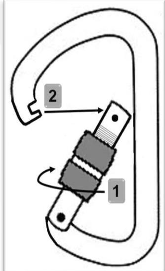
**Twist-Lock-Verschluss** – 1 Drehen dann 2 Öffnen
