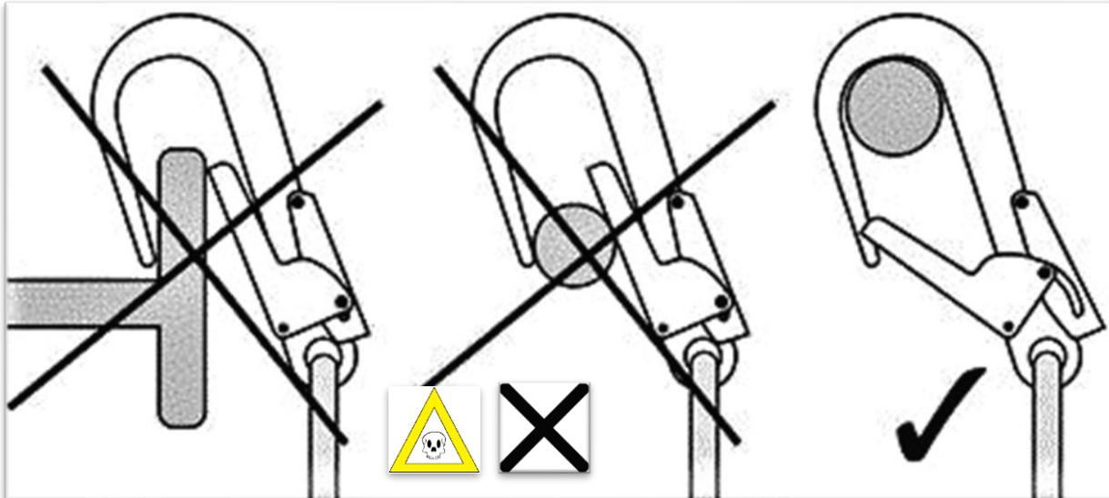
Seile nie über eine Karabinerverriegelung bzw. Karabinerverschluss führen.
